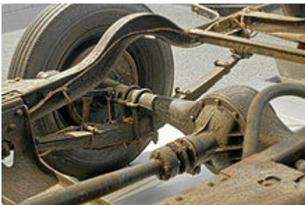
Antriebswelle zur Hinterachse an einem [Škoda 422](#)
