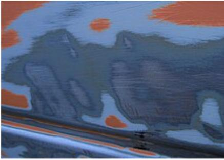
Durchgeschliffener Autolack bis aufs Blech zeigt den Aufbau
