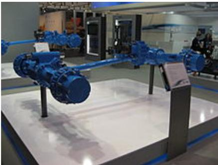
Antriebsstrang einer Baumaschine
