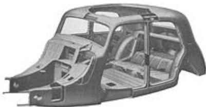
Eines der ersten Blechmonocoques im Fahrzeugbau: Karosserie des Citroën 11CV
