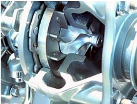
VTG mit angestellten Schaufeln in der Position für maximale Leistung
