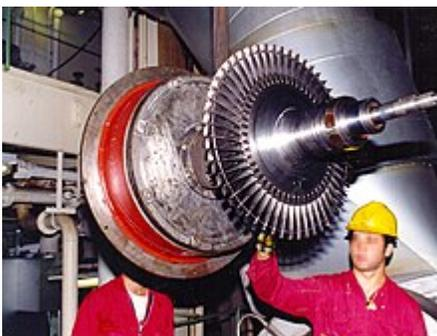
Welle eines Schiffsdiesel-Turboladers (ABB-VTR), Turbinenseite
