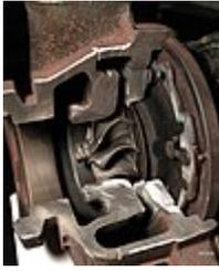
Abgasseite mit Turbinenrad und Leitradverstellung
