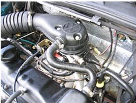
Bosch Mono-Motronic auf einem 1,8-Liter-Motor mit 66 kW (90 PS) von VW (MKB: RP, Bj. 1991)
