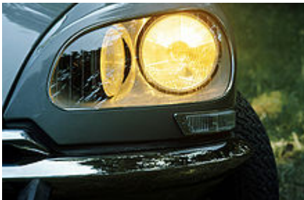
Per Seilzug gesteuerter Scheinwerfer im Citroën DS
