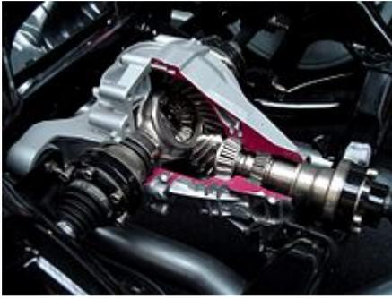
Differentialgetriebe: [Kegelradritzel](#) treibt Tellerrad an
