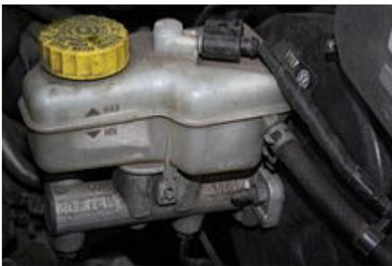
Bremsflüssigkeitsbehälter (oben) und Hauptbremszylinder (unten) in einem Škoda Fabia I
