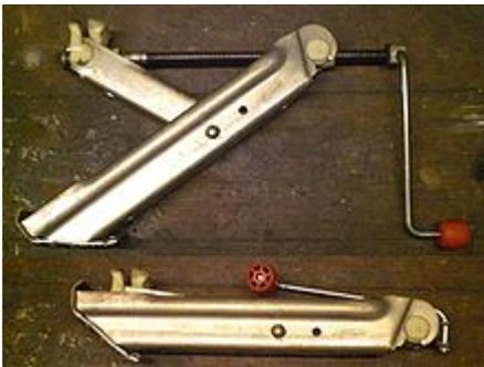
Bord-Wagenheber, oben: einsatzbereit (oben links: Aufnahme, unten links: Fuß, rechts: Kurbel). Unten: zusammengefaltet
