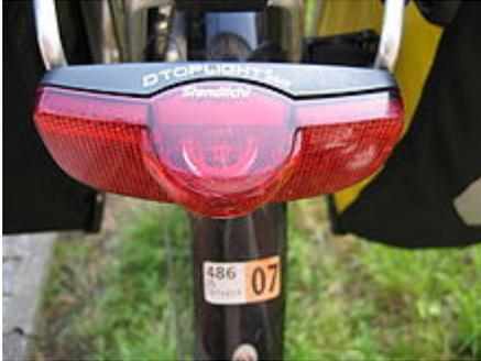
Fahrradrücklicht mit [Leuchtdioden](#) und Standlicht-Energieversorgung durch [Doppelschicht-Kondensator](#)
